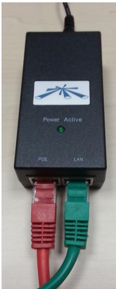
1. Utilizzando uno dei cavi rete in dotazione, collegare un estremo in una qualsiasi porta LAN del Gateway e l'altro estremo del cavo nella porta "LAN" dell'alimentatore (nell'immagine cavo di colore verde).
